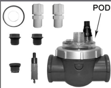
Der „POD-Bausatz“ ist ein Zubehör, das es erlaubt, an einer Stelle mehrere Messsonden anzubringen, falls Chlor Perfect-Regler mit einem pH Perfect Zodiac verwendet wird (oder mit einem anderen Regler mit einer Sonde mit 12 mm Durchmesser).
