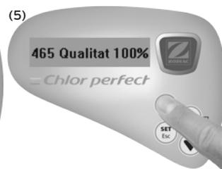
4. Die Taste „CAL/Enter“ 5 Sekunden lang niederhalten, bis „Calibrage“ auf dem LCD angezeigt wird (Abbildung 4a). Wieder die Taste „CAL/Enter“ drücken, wie auf dem Display angezeigt, um das Kalibrieren auf 465 mV zu starten (Abbildung 4b).
