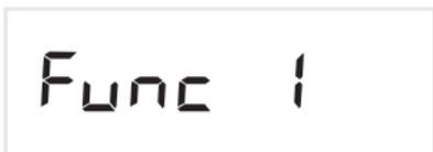
Dieser wird durch die Info-Anzeige „Func“ (function) angezeigt. In diesem Menü-Punkt wird die Funktion des Gerätes eingestellt. Der Wert kann mit den Tasten „**▲▼**“ geändert werden. Die Einstellung wird mit der Taste „**SET**“ bestätigt und das Gerät wechselt zum nächsten Menü-Punkt.
