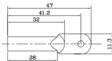
Der Ersatz-Tempersensoren TS 1 Metall ist auf Basis eines ICs der Fa. Maxim aufgebaut und für einen Temperaturbereich von  $-55$  bis  $+125^{\circ}\text{C}$  geeignet. Der Messfühler mit PVC-Anschlusskabel ist zur Messung im Freien, an Oberflächen oder in nicht aggressiven Gasen bestimmt.
