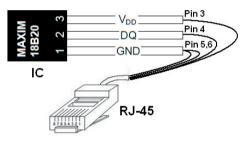
Der Fühler kann optional bis zu 50 Meter mit einem Netzwerkkabel und einem 2 x RJ45-Adapter verlängert werden. (siehe nachfolgende Abb.)
