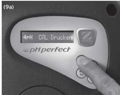
9. Für die Kalibrierung auf pH4 die Taste "CAL/Enter" drücken. Wie auf dem Display angegeben erneut die Taste "CAL/Enter" drücken (9a).
