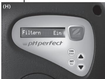
Aktivieren Sie zur Änderung dieser Funktion die Auswahlliste nach dem Öffnen des Menüs «Parameter», indem Sie die Taste «CAL/Enter» drücken (ein kleiner Pfeil erscheint rechts auf dem Display und der Zustand der Funktionserkennung der Filteranlage blinkt), und wählen Sie dann «On» oder «Off» mittels der Navigationstasten "▲" und "▼" aus (H).
