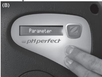
→ Zum Einsteigen in das Menü «Parameter», muss das Gerät eingeschaltet sein. Drücken Sie gleichzeitig ca. 5 Sekunden lang die Tasten «CAL/Enter» und «SET/Esc» bis vom LCD-Display «Parameter» angezeigt wird. (B).
