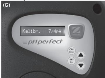
Die Kalibrierung des pH Perfect wird standardmäßig in 2 Schritten durchgeführt: pH7 und pH4 (G).
