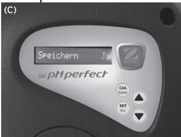
→ Um das Menü «Parameter» zu verlassen, die Taste «SET/Esc» drücken und «Ja» oder «Nein» mittels der Navigationstaste "▲" und "▼" auswählen, um die neuen Einstellungen zu speichern oder zu verwerfen. Bestätigen Sie Ihre Wahl durch Drücken der Taste «CAL/Enter» (C).
