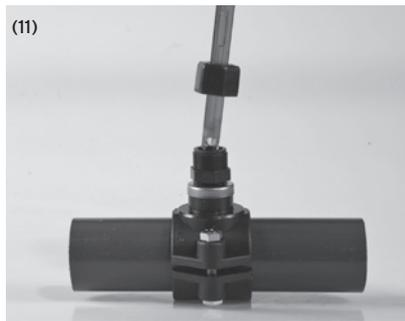
11. Die Sonde in sauberem Wasser spülen. Danach durch leichtes Schütteln von überflüssigem Wasser befreien und sie wieder im Sondenhalter befestigen (sie darf den Schlauch nicht berühren).
