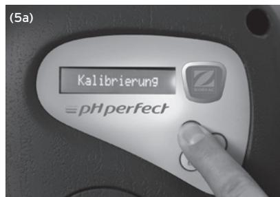
5. Die Taste "CAL/Enter" 5 Sekunden lang bis zur Anzeige des Textes "Kalibrierung" auf dem LCD-Display (5a) gedrückt halten.
