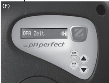
Der pH Perfect ist mit einer Schutzeinrichtung ausgerüstet, die jegliche Gefahr einer Überdosierung von Korrekturflüssigkeit, beispielsweise im Fall einer Störung der pH-Sonde, vermeidet. Diese als «OFA» (Over Feed Alarm) bezeichnete Schutzeinrichtung hat zum Ziel, das Gerät auf Pause zu stellen, wenn der Sollwert nicht nach der auf standardmäßig 4 Stunden eingestellten Zeit erreicht ist (F).
